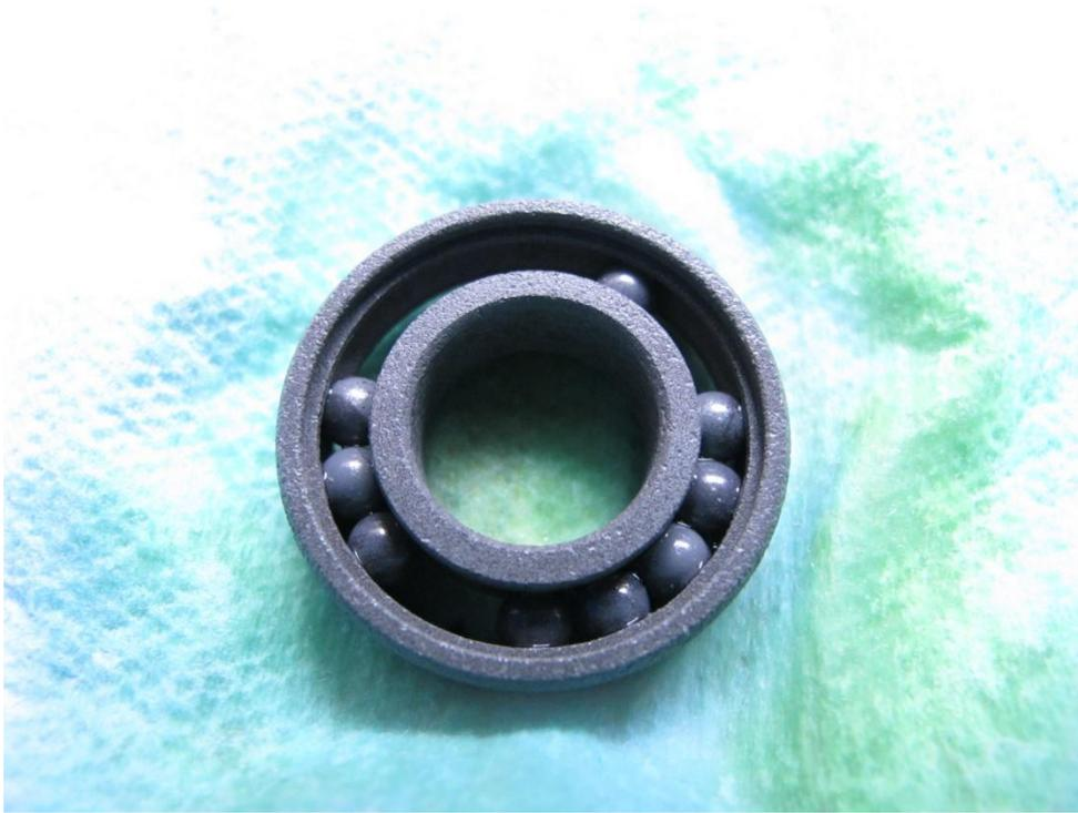
尼龍保持器完全腐蝕，軸承表面腐蝕成孔洞狀，unqualified。
