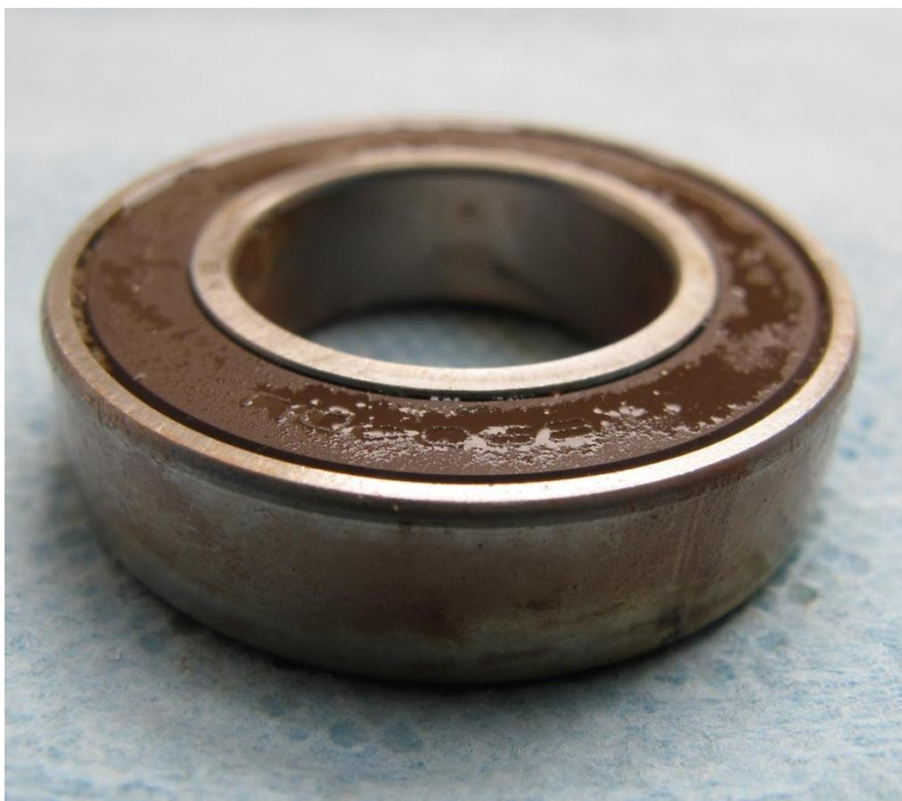
⑥ 測試樣本 a.CAM-pro bearings SC6002 NS 置於鹽水 50%三日後 6/11 取樣:
